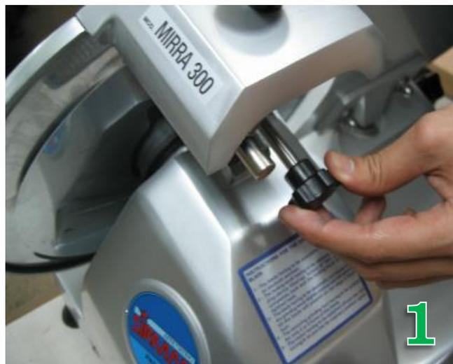
逆時鐘將後方刀盤護蓋螺絲鬆開
