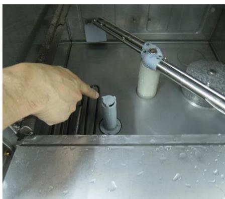
各線路接好後(乾劑吸管拉出來放著就可以)，並務必將排水孔插好
